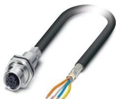
Connettore per apparecchi posteriore, PROFINET CAT5 (100 MBit/s) CAT5 (100 MBit/s), 4-poli, Femmina, diritto, M12-SPEEDCON, codifica: D, su estremità conduttore libera, Montaggio posteriore, Collegamento del cavo, lunghezza cavo: 2 m, Questo articolo è in continuo adattamento. Alternativa senza piombo secondo RoHS II senza eccezione 6c (Pb < 0,1%) possibile in anticipo su richiesta.
