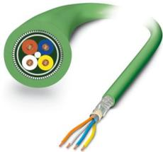
In metri, Cavo dati, PROFINET CAT5 (100 MBit/s), EtherCAT® CAT5 (100 MBit/s), schermata, PUR senza alogenati, verde RAL 6018, 4-conduttori (1x4xAWG22/19, S/TQ), colore conduttore singolo: bianco, giallo, blu, arancio, lunghezza cavo: 100 m
