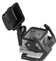
Custodia da incasso B6, con blocc. longitudinale, materiale: Pressofuso di alluminio, impermeabile, materiale coperchio: PC, altezza: 30,5 mm, connessione a vite per cavo: senza, coperchio di protezione: sì, Standard, con guarnizione piatta
