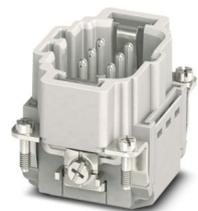
Inserto contatti, numero poli: 6+PE, dimensioni: B6, numero di connessioni per polo: 1, Spina, Connessione Push-in, 500 V, 16 A, 0,14 mm<sup>2</sup> ... 2,5 mm<sup>2</sup>, applicazione: Potenza
