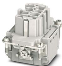
Inserto contatti, numero poli: 6+PE, dimensioni: B6, numero di connessioni per polo: 1, Femmina, Connessione Push-in, 500 V, 16 A, 0,14 mm<sup>2</sup> ... 2,5 mm<sup>2</sup>, applicazione: Potenza
