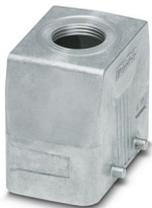
Custodia protettiva B10, per bloccaggio trasversale, materiale: Pressofuso di alluminio, impermeabile, uscite cavi: 1, diritto, 1x M25, altezza: 57 mm, connessione a vite per cavo: senza, Standard
