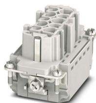
Insetto contatti, numero poli: 10+PE, dimensioni: B10, numero di connessioni per polo: 1, Femmina, Connessione Push-in, 500 V, 16 A, 0,14 mm<sup>2</sup> ... 2,5 mm<sup>2</sup>, applicazione: Potenza
