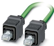
Cavo PROFINET confezionato, CAT5e, schermato, stella quadrupla, AWG 22 per catena portacavi (7 fili), RAL 6018 (giallo-verde), connettore RJ45/IP67, Push-Pull, custodia in plastica, su connettore RJ45/IP67, Push-Pull, custodia in plastica, Line, lunghezza 5 m
