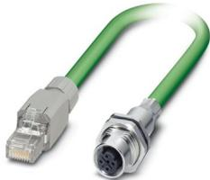
Cavo PROFINET confezionato, CAT5e, schermato, stella quadrupla, AWG 22 per catena portacavi (7 fili), RAL 6018 (giallo-verde), connettore RJ45/IP20 su connettore femmina da incasso M12, montaggio posteriore/a vite con filettatura M16, Line, lunghezza 2 m
