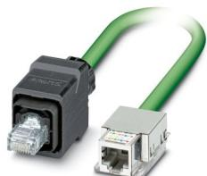
Cavo PROFINET confezionato, CAT5e, schermato, Sternvierer, AWG 22 flessibile (7 fili), RAL 6018 (giallo-verde), modulo femmina RJ45/IP20 per sistema Freenet, 4 poli su connettore maschio RJ45/IP67 Push-Pull, custodia in plastica, Line, lunghezza: 2 m
