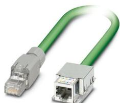
Cavo PROFINET confezionato, CAT5e, schermato, Sternvierer, AWG 22 flessibile (7 fili), RAL 6018 (giallo-verde), modulo femmina RJ45/IP20 per sistema Freenet, 4 poli su connettore maschio RJ45/IP20, Line, lunghezza: 2 m
