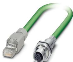
Cavo PROFINET confezionato, CAT5e, schermato, Sternvierer, AWG 22 flessibile (7 fili), RAL 6018 (giallo-verde), connettore maschio RJ45/IP20 su connettore femmina da incasso M12, montaggio posteriore/a vite con filettatura M16, Line, lunghezza: 2 m
