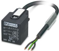
Cavo sensore/attuatore, 3-poli, PVC, nero RAL 9005, estremità conduttore libera, su Connettore per valvole A, con 1 LED, Circuito: Diodo di smorzamento, lunghezza cavo: 5 m
