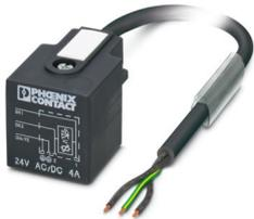
Cavo sensore/attuatore, 3-poli, PVC, nero RAL 9005, estremità conduttore libera, su Connettore per valvole A, con 1 LED, Circuito: Varistore, lunghezza cavo: 1,5 m
