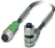
Cavo sensore/attuatore, 5-poli, PVC, nero RAL 9005, Maschio diritto M12, codifica: A, con 3 LED, su Connettore femmina angolato M12, codifica: A, con 3 LED, lunghezza cavo: 0,3 m
