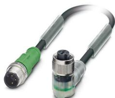
Cavo sensore/attuatore, 3-poli, PVC, nero RAL 9005, Maschio diritto M12, codifica: A, con 2 LED, su Connettore femmina angolato M12, codifica: A, con 2 LED, lunghezza cavo: 0,6 m
