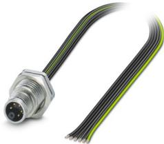
Connettore per apparecchi posteriore, Potenza, 6-poli, Connettore, diritto, M12-Standard, codifica: M, su estremità conduttore libera, Montaggio posteriore, M16 x 1,5, Fili singoli, lunghezza cavo: 0,2 m, 1,31 mm<sup>2</sup>, Filo per l'elettronica UL/cUL, saldato, Questo articolo è in continuo adattamento. Alternativa senza piombo secondo RoHS II senza eccezione 6c (Pb < 0,1%) possibile in anticipo su richiesta.
