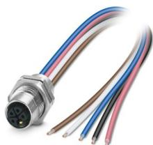
Connettore per apparecchi posteriore, Potenza, 5-poli, Femmina, diritto, M12-Standard, codifica: L, su estremità conduttore libera, Montaggio posteriore, M16 x 1,5, Fili singoli, lunghezza cavo: 0,2 m, 2,50 mm<sup>2</sup>, Filo in PEX, saldato, Prodotto alternativo secondo RoHS II senza eccezione 6c (Pb < 0,1 %) cod. art.: 1239085
