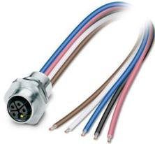
Connettore per apparecchi anteriore, Potenza, 5-poli, Femmina, diritto, M12-Standard, codifica: L, su estremità conduttore libera, Montaggio anteriore, M16 x 1,5, Fili singoli, lunghezza cavo: 0,2 m, 2,50 mm<sup>2</sup>, Filo in PEX, saldato, Prodotto alternativo secondo RoHS II senza eccezione 6c (Pb < 0,1 %) cod. art.: 1239083
