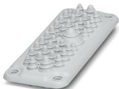
Piastre di ingresso, numero dei conduttori: 37, diametro esterno conduttore: 4x 6 mm ... 10 mm, 14x 8 mm ... 12 mm, 16x 10 mm ... 14 mm, 2x 12 mm ... 18 mm, 1x 17 mm ... 32 mm, materiale: lamiera di acciaio zincata (Nucleo), materiale: TPE-SEBS (materiale esterno), colore: grigio chiaro, lunghezza: 222 mm, larghezza: 92 mm, altezza: 29,5 mm
