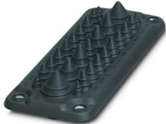
Piastre di ingresso, numero dei conduttori: 27, diametro esterno conduttore: 4x 5 mm ... 7 mm, 4x 8 mm ... 12 mm, 13x 10 mm ... 14 mm, 4x 14 mm ... 20 mm, 2x 20 mm ... 26 mm, materiale: lamiera di acciaio zincata (Nucleo), materiale: TPE-SEBS (materiale esterno), colore: nero, lunghezza: 222 mm, larghezza: 92 mm, altezza: 29,5 mm
