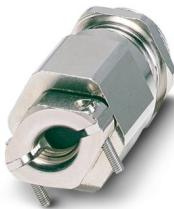
Pressacavi, materiale connessione a vite: Ottone, nichelato, applicazione: Standard, diametro esterno cavo 13 mm ... 21 mm, schermatura: no, filettatura: M32 x 1,5, colore: argento, con fermacavo, con O-ring
