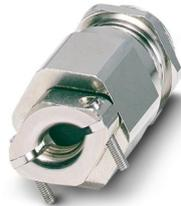
Pressacavi, materiale connessione a vite: Ottone, nichelato, applicazione: Standard, diametro esterno cavo 6 mm ... 13 mm, schermatura: no, filettatura: M20 x 1,5, colore: argento, con fermacavo, con O-ring
