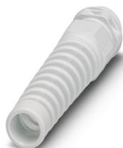
Pressacavi, materiale connessione a vite: PA, applicazione: Standard, diametro esterno cavo 3 mm ... 7 mm, schermatura: no, filettatura: M12 x 1,5, colore: grigio luce RAL 7035, con protezione anti piega
