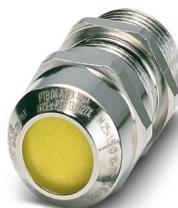
Pressacavi, materiale connessione a vite: Ottone, nichelato, applicazione: Ex, diametro esterno cavo 16 mm ... 28 mm, schermatura: sì, filettatura: M40 x 1,5, colore: argento, con O-ring
