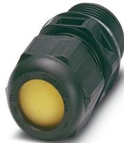
Pressacavi, materiale connessione a vite: PA, applicazione: Ex, diametro esterno cavo 23 mm ... 35 mm, schermatura: no, filettatura: M50 x 1,5, colore: nero intenso, con guarnizione piatta
