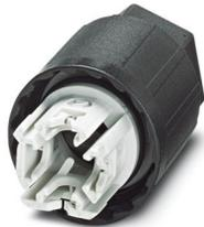
Dado, product family: QPD, tipo di connessione: Connessione IDC, numero poli: 2+PE, 0,5 mm<sup>2</sup> ... 1,5 mm<sup>2</sup>, 690 V, 17,5 A, PA, nero, diametro esterno conduttore: 10 mm ... 13 mm
