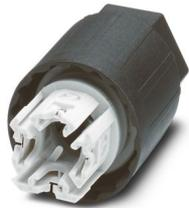
Dado, product family: QPD, tipo di connessione: Connessione IDC, numero poli: 3+PE, 0,5 mm<sup>2</sup> ... 1,5 mm<sup>2</sup>, 690 V, 17,5 A, PA, nero, diametro esterno conduttore: 10 mm ... 13 mm
