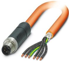
Cavo di alimentazione, 6-poli, PUR senza alogenati, arancio RAL 2003, schermata (Advanced Shielding Technology), Maschio diritto M12, codifica: M, su estremità conduttore libera, lunghezza cavo: 3 m, per corrente alternata fino a 8 A/690 V
