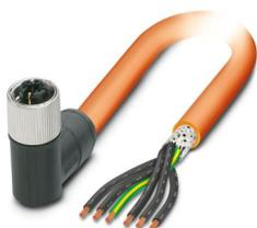
Cavo di alimentazione, 6-poli, PVC, arancio RAL 2003, schermata (Advanced Shielding Technology), estremità conduttore libera, su Connettore femmina angolato M12, codifica: M, lunghezza cavo: 5 m, per corrente alternata fino a 8 A/690 V
