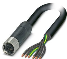
Cavo di alimentazione, 6-poli, PVC, grigio-nero RAL 7021, estremità conduttore libera, su Connettore femmina diritto M12, codifica: M, lunghezza cavo: 1,5 m, per corrente alternata fino a 8 A/690 V
