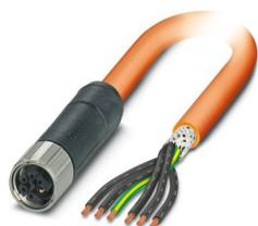
Cavo di alimentazione, 6-poli, PUR senza alogenati, arancio RAL 2003, schermata (Advanced Shielding Technology), estremità conduttore libera, su Connettore femmina diritto M12, codifica: M, lunghezza cavo: 1,5 m, per corrente alternata fino a 8 A/690 V
