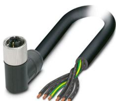
Cavo di alimentazione, 6-poli, PUR senza alogenati, grigio-nero RAL 7021, estremità conduttore libera, su Connettore femmina angolato M12, codifica: M, lunghezza cavo: 1,5 m, per corrente alternata fino a 8 A/690 V
