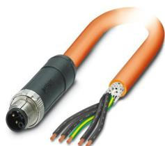
Cavo di alimentazione, 5-poli, PUR senza alogenati, arancio RAL 2003, schermata (Advanced Shielding Technology), Maschio diritto M12, codifica: K, su estremità conduttore libera, lunghezza cavo: 10 m, per corrente alternata fino a 16 A/690 V
