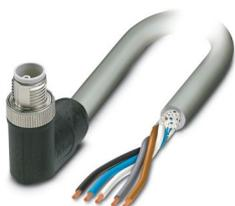
Cavo di alimentazione, 5-poli, PVC, grigio RAL 7001, schermata (Advanced Shielding Technology), Maschio angolato M12, codifica: L, su estremità conduttore libera, lunghezza cavo: 5 m, per corrente continua fino a 16 A / 63 V
