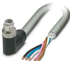
Cavo di alimentazione, 5-poli, PUR senza alogenati, grigio RAL 7001, schermata (Advanced Shielding Technology), Maschio angolato M12, codifica: L, su estremità conduttore libera, lunghezza cavo: 1,5 m, per corrente continua fino a 16 A / 63 V
