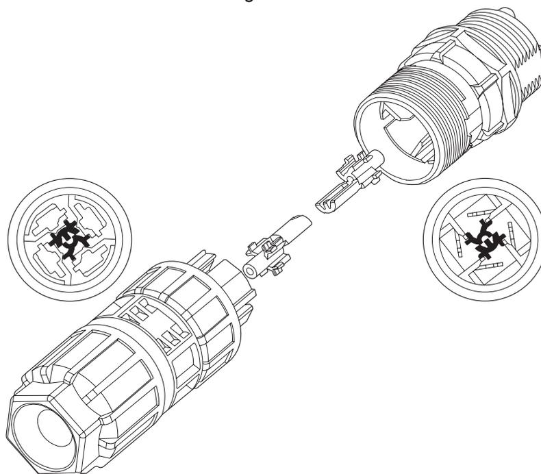
Codifica della connessione QUICKON
