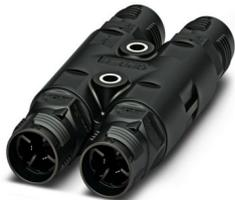
Distributore a H, product family: QPD, tipo di connessione: Connessione IDC/ Attacco rapido QUICKON, numero poli: 2+PE, 0,5 mm<sup>2</sup> ... 1,5 mm<sup>2</sup>, 690 V, 17,5 A, PA, nero, senza dado QUICKON, codifica: Profilo di codifica
