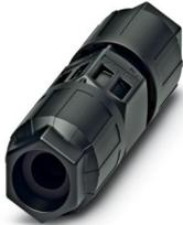
Connettori per cavi, product family: QPD, tipo di connessione: Connessione IDC, numero poli: 3+PE, 0,5 mm<sup>2</sup> ... 1,5 mm<sup>2</sup>, 690 V, 17,5 A, PA, nero, con due dadi QUICKON, codifica: Profilo di codifica, diametro esterno conduttore: 5 mm ... 7 mm e 7 mm ... 9,5 mm
