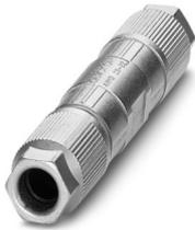
Connettore per cavi, 8 poli, privo di alogenati, schermato, connessione rapida a perforazione di isolante, materiale custodia: pressofuso di zinco, nichelato, diametro esterno cavo 5 mm ... 9,7 mm
