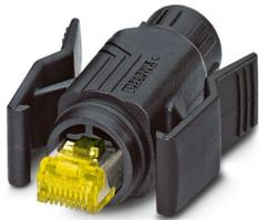
Connettore RJ45, tipo: RJ45, grado di protezione: IP67, numero poli: 8, 10 Gbit/s, CAT6<sub>A</sub>, materiale: Plastica, tipo di connessione: Connessione a crimpare, sezione di connessione: AWG 24- 27, uscita cavo: diritto, colore: nero, Ethernet/PROFINET
