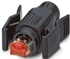
Connettore RJ45, tipo: RJ45, grado di protezione: IP67, numero poli: 8, 1 Gbit/s, CAT6, materiale: Plastica, tipo di connessione: Connessione a crimpare, sezione di connessione: AWG 24- 27, uscita cavo: diritto, colore: nero, Ethernet/PROFINET
