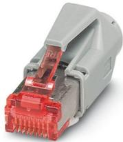
Connettore RJ45, tipo: RJ45, grado di protezione: IP20, numero poli: 8, 1 Gbit/s, CAT6, materiale: Plastica, tipo di connessione: Connessione a crimpare, sezione di connessione: AWG 24- 27, uscita cavo: diritto, colore: grigio, Ethernet
