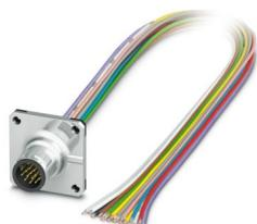
Connettore per apparecchi anteriore, 12-poli, Connettore, M12, codifica: A, su estremità conduttore libera, Montaggio anteriore/flangia quadrata, Fili singoli, lunghezza cavo: 0,07 m, 0,08 mm<sup>2</sup>, saldato, Questo articolo è in continuo adattamento. Alternativa senza piombo secondo RoHS II senza eccezione 6c (Pb < 0,1%) possibile in anticipo su richiesta.
