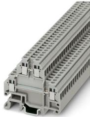
Micromorsetti, tensione nominale: 400 V, corrente nominale: 17,5 A, tipo di connessione: Connessione a vite, 1. e 2. piano, Sezione di dimensionamento: 1,5 mm<sup>2</sup>, sezione: 0,14 mm<sup>2</sup> - 1,5 mm<sup>2</sup>, tipo di montaggio: NS 15, NS 35/7,5, NS 35/15, colore: grigio
