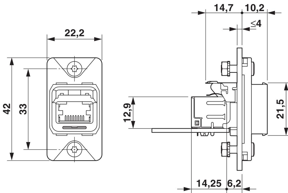
Dima di forat./geometria di pad di saldat.
