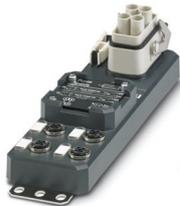
Distributore Power, applicazione: Alimentazione di energia, tipo di connessione: Connettore femmina M12 Metallo, numero degli slot: 4, numero poli: 4, codifica: T, occupazione slot: singolo, segnalazione di stato: sì, Universale; connessione linea principale: Connessione linea principale a innesto 90°, schermatura: no
