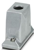
Custodia mobile HEAVYCON ADVANCE, B16, con bloccaggio a vite (esagono cavo) in acciaio inox, alluminio impermeabile, altezza 93,7 mm, con filettatura, uscita cavo diritta 1x M32, senza superficie, guarnizione conduttiva (caratteristiche EMC)
