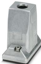
Custodia mobile HEAVYCON ADVANCE B6, con bloccaggio a vite (esagono cavo) in acciaio inox, alluminio impermeabile, altezza 93,7 mm, con filettatura 1x M32, uscita cavo diritta, senza superficie; guarnizione conduttiva (caratteristiche EMC)
