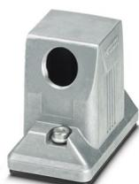
Custodia mobile HEAVYCON ADVANCE B6, con bloccaggio a vite (esagono cavo) in acciaio inox, alluminio impermeabile, altezza 74 mm, con filettatura 1x M25, uscita cavo laterale, senza superficie; guarnizione conduttiva (caratteristiche EMC)
