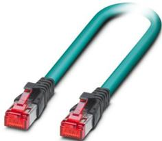
Cavo patch, grado di protezione: IP20, lunghezza cavo: 20 m, numero poli: 8, 10 Gbit/s, CAT6<sub>A</sub>, tipo di connessione: Connessione Pierce, Ethernet
