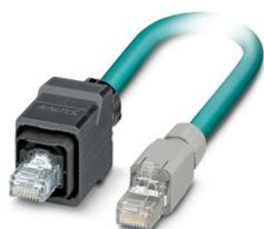
Cavo Ethernet confezionato, schermato, 4 coppie, AWG 26 con catene portacavi (19 fili), RAL 5021 (azzurro mare), connett. maschio RJ45/IP67 Push-Pull custodia in plastica su connett. maschio RJ45/IP20, Line, lungh. 2 m
