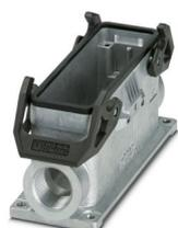
Custodia a zoccolo B24, con blocc. trasversale, materiale: Pressofuso di alluminio, impermeabile, uscite cavi: 2, laterali, 2x M25, altezza: 68 mm, connessione a vite per cavo: senza, Standard
